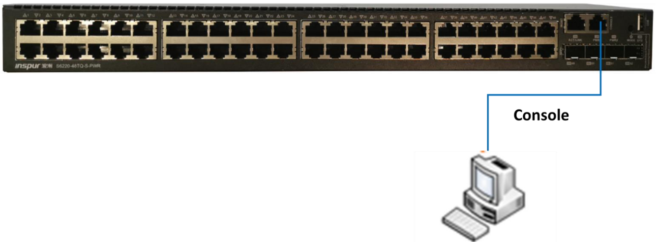
图 3-1 通过 Console 口搭建本地配置环境
